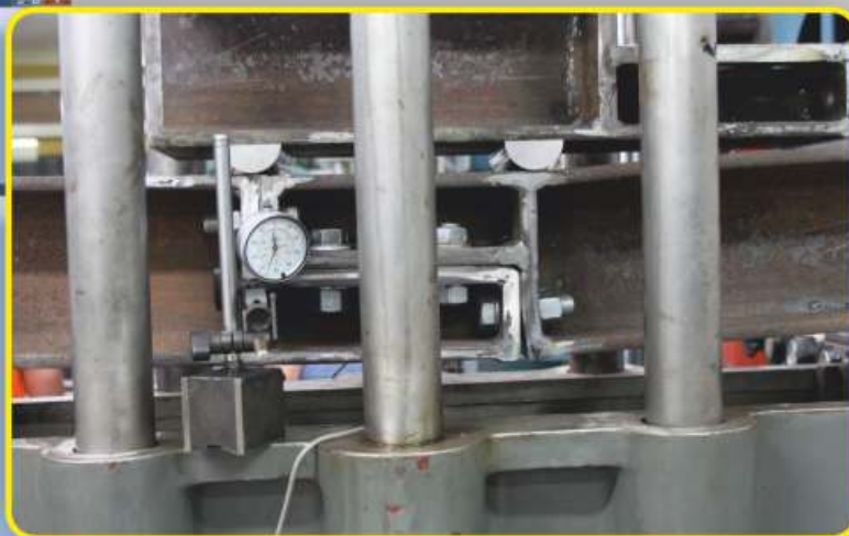
Esecuzione della prova: deformazione in campo plastico del nodo
